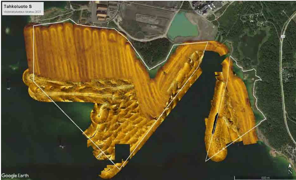
Kuva 12. Mosaiikkikuva viistokaikuluotausaineistosta Tahkoluodon eteläpuolelta. Alue jakaantuu kahteen osaan, koska keskellä on jo aiemmin vuonna 2022 tutkittu alue. Kahdesta nyt tutkitusta alueesta suurempi läntinen alue on kooltaan 195,3ha ja pienempi itäinen on kooltaan 41,8ha. Alueen eteläisin kulma on myös viistokaiutettu ja siitä on analysoitu data. Google Maps jättää neliön muotoisen kohdan overlay-kuvasta jostain syystä tyhjäksi. Kolmion muotoinen alue, jossa pohja näkyy vaaleana, on liian matalaa luotaukseen.
