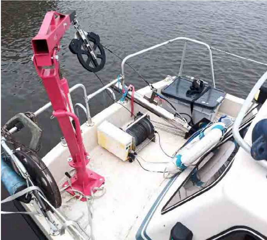
Kuva 10. Viistokaikuluotauksessa käytettiin DSME Sonar Beam UTech S-150S viistokaikuluotain laitteistoa, jonka lähetystaajuus oli 400kHz.
