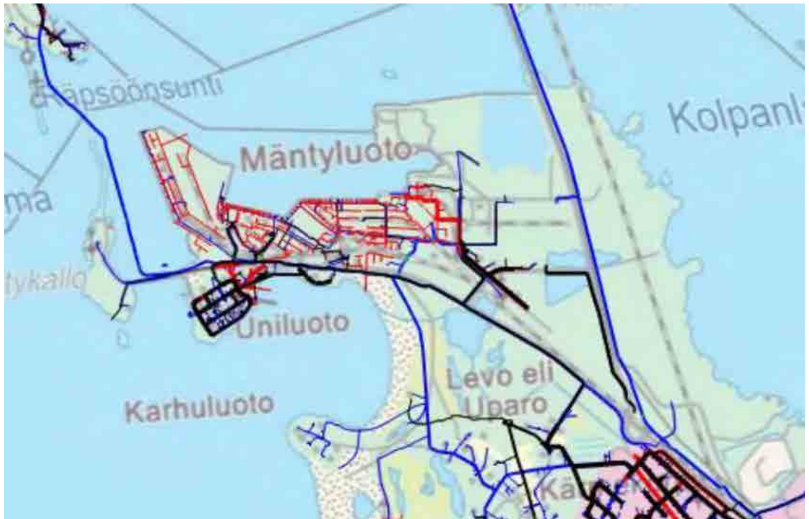
Kuva 13. Ote vesihuollon verkostokartasta. Sinisellä puhdas vesi, punaisella sadevesiviemäri ja mustalla jäte- ja sekavesiviemäri.
